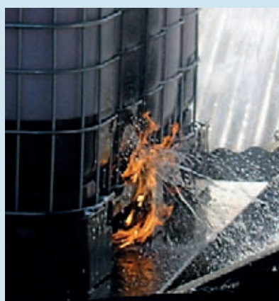
Figuren 11 en 12: HSE test beperkte vuurlast (krantenprop) onder een IBC en het directe gevolg. (Bron: HSE rapport)
